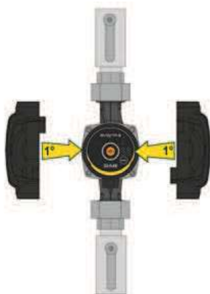
Afbeelding 7: Isolatie van het pomphuis
